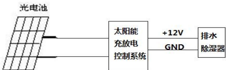
图 1：太阳能型电柜排水除湿系统
